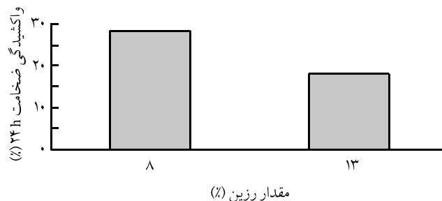
شکل ۱۲ - اثر مستقل مقدار رزین بر واکشیدگی ضخامت ۲۴ h تخته‌های ساخته شده از رزین AESO.
