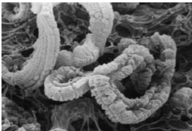
شکل ۲ - تصویر SEM از لایه زغال اسفنج پر شده با EG [۷۳].
