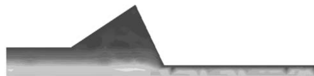
شکل ۷ - توزیع نمودارهای هم‌اندازه سرعت در اکسترودر آزمایشگاهی ( T = 100^{\circ}\text{C} و N = 40 \text{ rpm} ).
