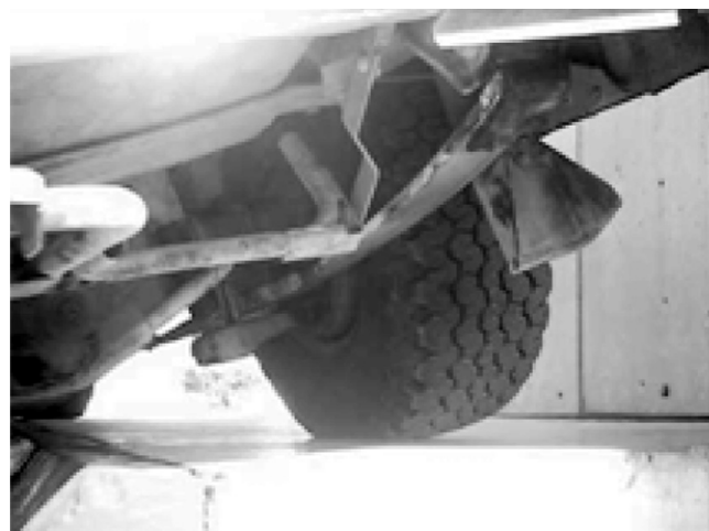
شکل ۶- تغییر شکل فنر هنگام قرارگیری یک چرخ خودرو بر روی بلندی.
