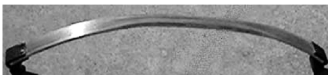
شکل ۳- فنر شمشلی ساخته شده از کامپوزیت پلیمری.
