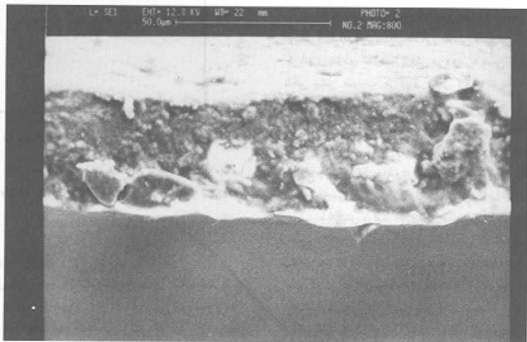
شکل ۱۳ - شکل شناسی غشای حاصل از سلولوز استات (۱۰ درصد حجمی) در مخلوط استون-دیوکسان به نسبت ۵۰:۵۰ و بستر ۱۰۰ درصد آب.
