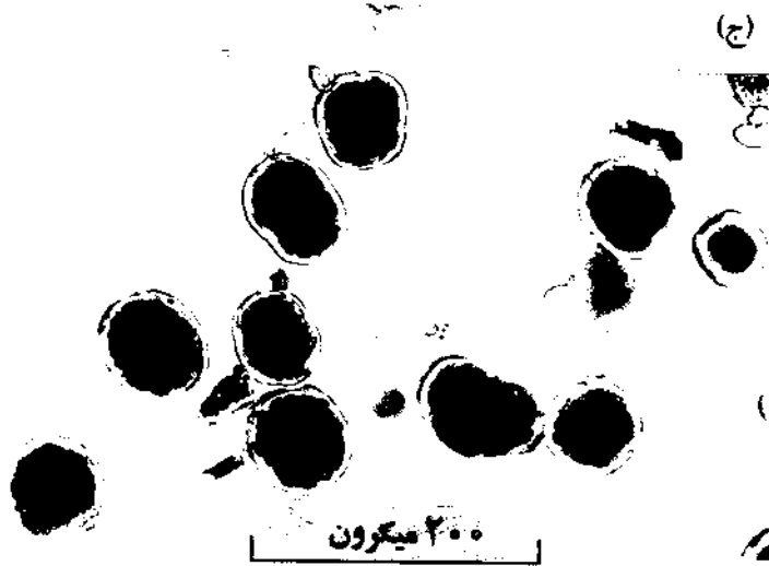
شکل ۲- تصاویر میکروسکوپی ریزکپسولهای تهیه شده در دور همزن: (الف) ۲۰۰۰ rpm (آزمایش ۱)، (ب) ۴۰۰۰ rpm (آزمایش ۲) و (ج) ۶۰۰۰ rpm (آزمایش ۳).
