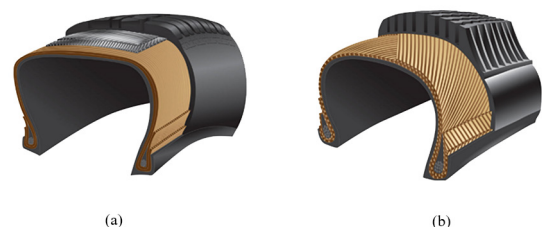
شکل ۱- قرارگیری الیاف در ساختار تایر: (a) رادیال و (b) اریبی [۹]. Fig. 1. Fiber placement in tire structure: (a) radial and (b) bias [9].
