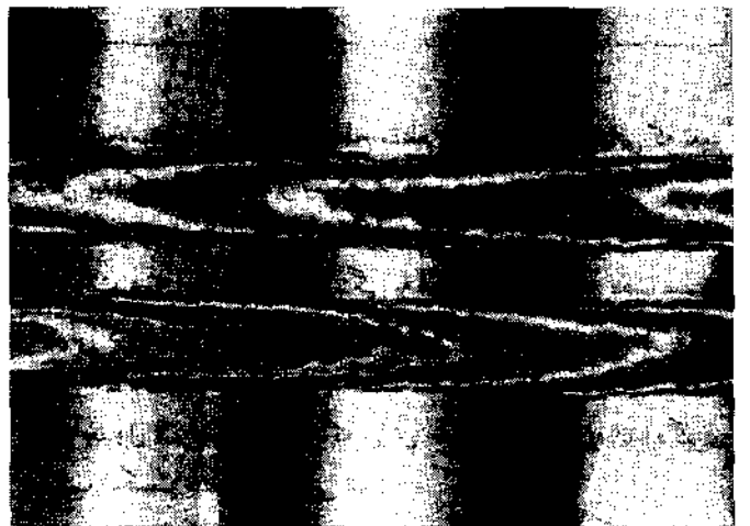
شکل ۷ - جابه جایی فریزهای تداخلی در الیاف پشم درون مایع با ضریب شکست ۱/۴۸۰
