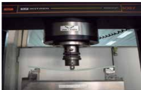
شکل ۴- آزمون خمش سه نقطه‌ای طبق استاندارد ASTM C393.
