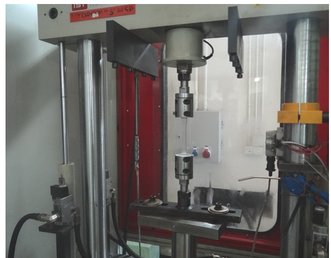
شکل ۱- دستگاه آزمون خستگی کشش - کشش با کنترل نیرو، نسبت تنش برابر با ۰/۱.
